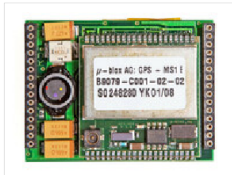
Module fournissant le signal GPS
