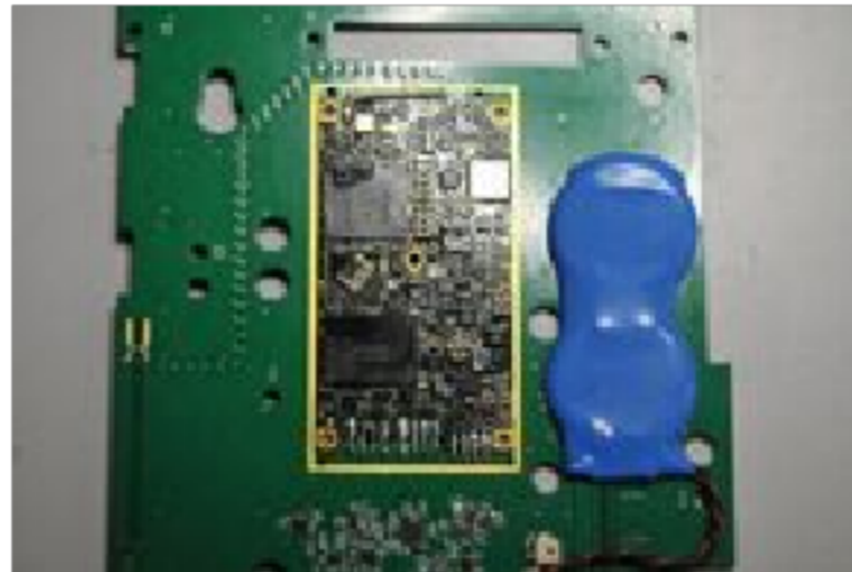
Version modifiée du plus grand circuit imprimé du téléphone, avec le cache du module isolé retiré.
