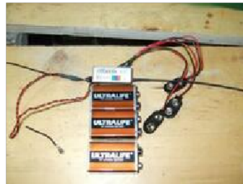
L'ensemble démonté. Les piles étaient déchargées.
